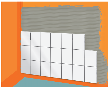
Afb. 6: Tegels worden geplaatst met een dunne laag FERMACELL Flexibele tegelijm op een volvlakse afdichting (garandeert de afdichting voor de vochtbelastingsklasse A)
