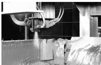
Afbeelding 1.2: Aanbrengen van de plaatlaag aan de malzijde
