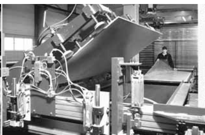
Afbeelding 1.3: Volautomatisch uit de mal nemen van de platen
