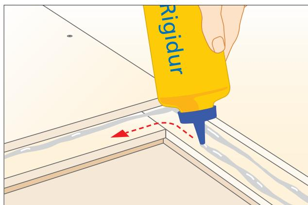
De estrichelementen worden tegen de randstroken gelegd. De elementen worden onderling verbonden met Rigidur estrichlijm, door twee rupsen lijm aan te brengen op de lip-verbinding. Het volgende element moet binnen 10 minuten worden aangebracht en gefixeerd met Rigidur schroeven of met spreidnieten op 25 mm vanaf de randen. Tijdens het aanbrengen van de schroeven of nieten wordt de liplasverbinding stevig met de voet aangedrukt.
