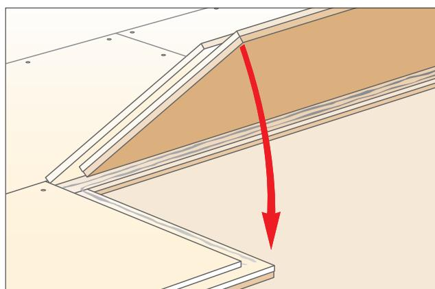
Houd de schroef- of nietlengtes uit de onderstaande tabel aan, om te voorkomen dat de bevestigingsmiddelen aan de onderzijde door de gipsvezellaag heen steken. Dat zou de geluidsisolatie of de vlakheid van de vloer nadrukkelijk beïnvloeden. Schroeven worden maximaal h.o.h. 250 mm geplaatst. Spreidnieten worden maximaal h.o.h. 150 mm en evenwijdig aan de plaatrand aangebracht.
