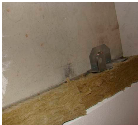
Abbildung 3 Angepasste Halteklammer für die Montage der Platte während der Prüfung
