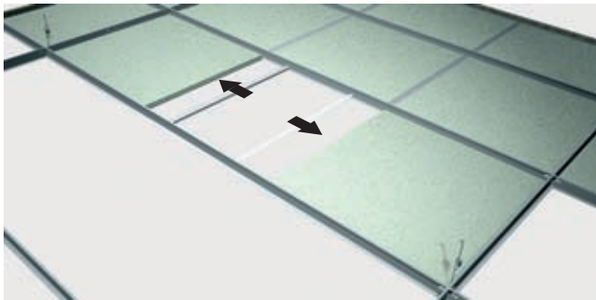
Stap 5: Twee klemprofielen in C-kantafwerking plaatsen.
